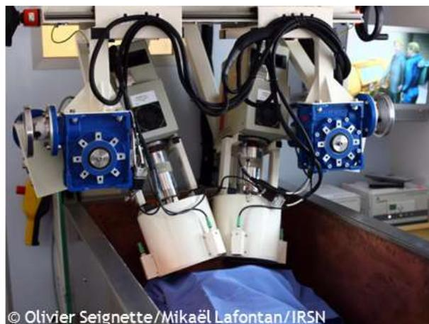
**Figure 12 - Mesure anthroporadiométrique pulmonaire à l'aide de détecteurs GeHP**
